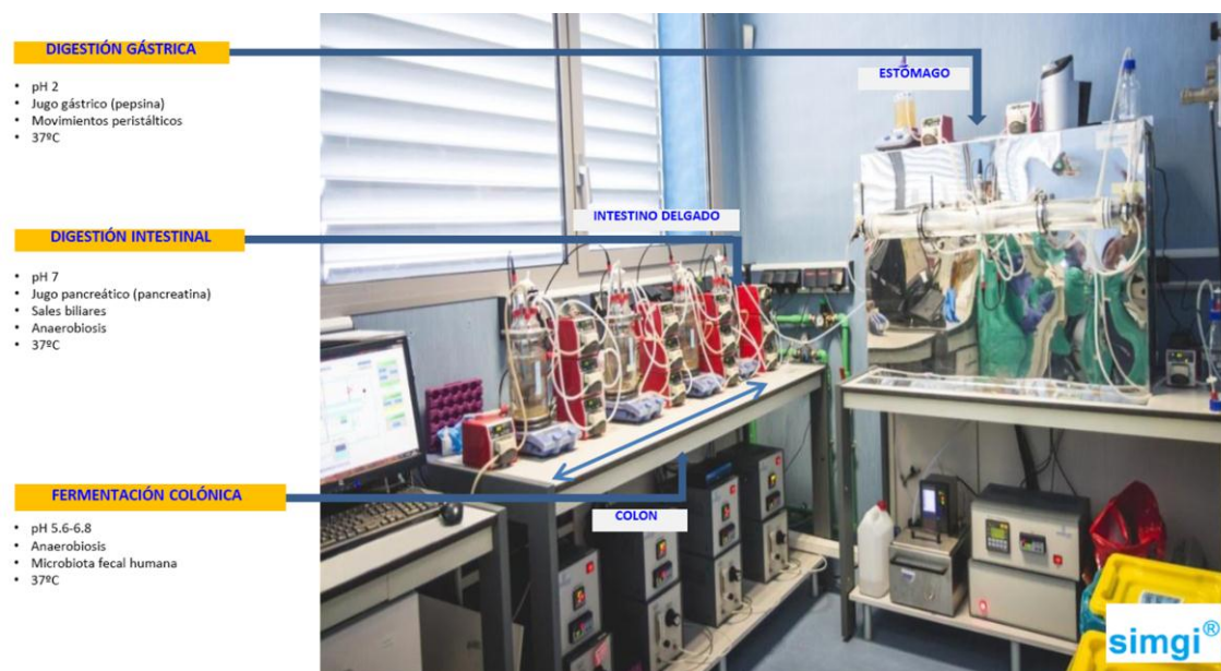
Presentación del Simulador Gastrointestinal Dinámico (simgi®) ubicado en el CIAL
